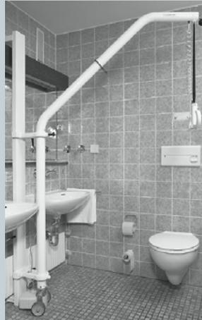
Die Boden-Wand-Stütze wird am Boden und an der Wand montiert. Sie eignet sich besonders dort, wo größere Hindernisse (z.B. Heizkörper) einen direkten Wandanbau verhindern.
